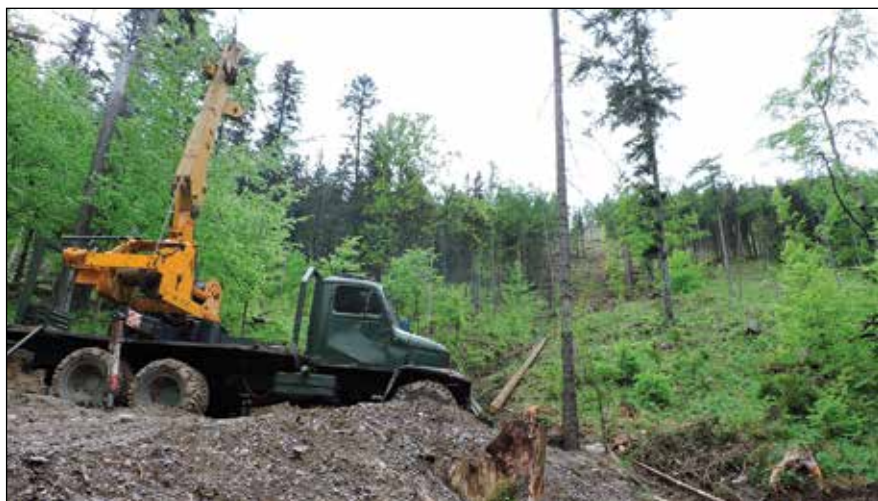
LESNÁ LANOVKA NA V3S PODVOZKU V BABEJ DOLINE PORAST 497, ROK 2017
